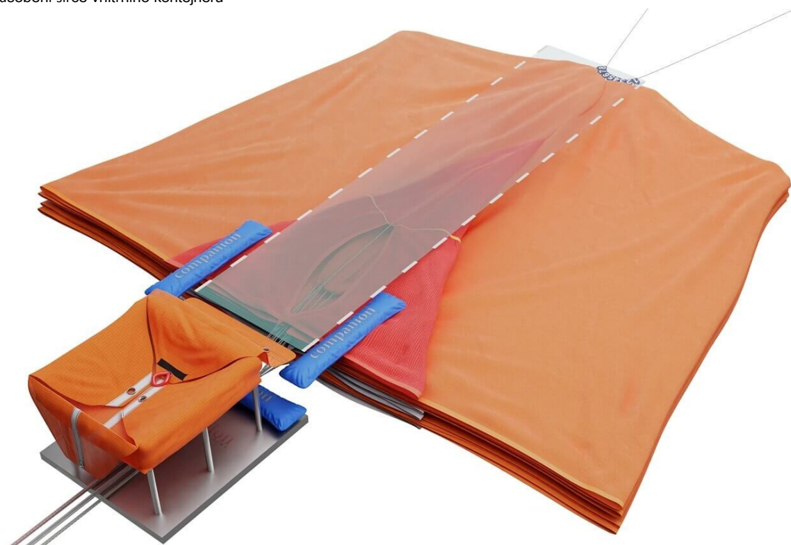
Obr. 34 Přizpůsobení šířky vnitřního kontejneru.
