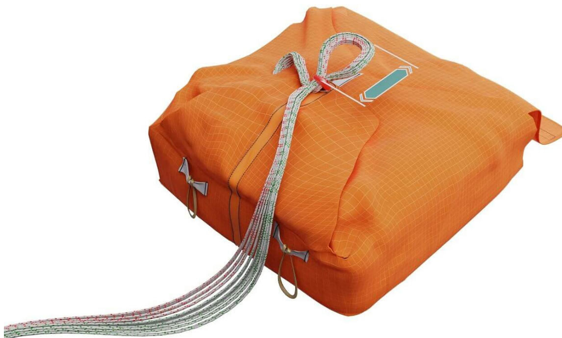
Obr. 47 Zkontrolujte délku lankové smyčky, která uzavírá poslední krycí plachtu kontejneru.
