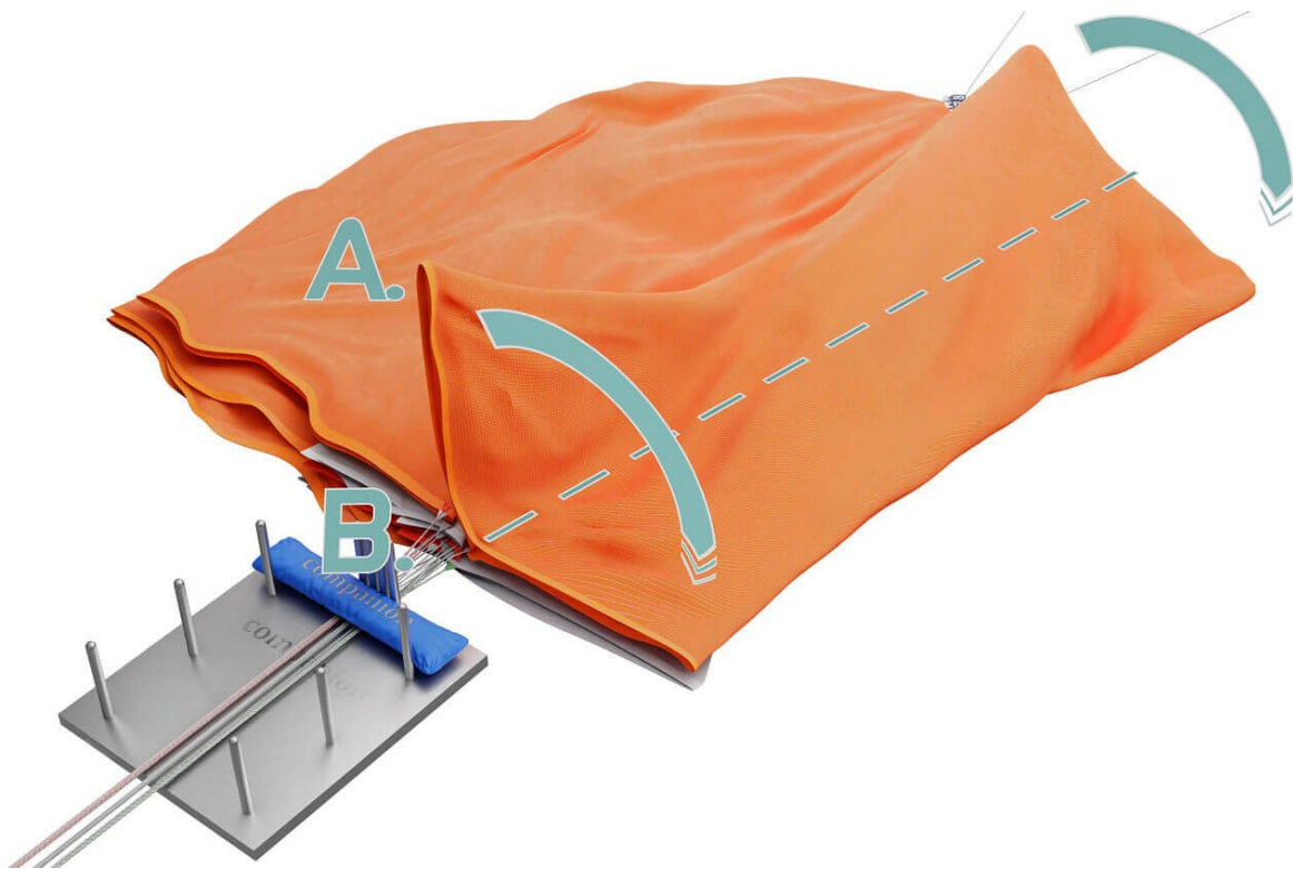
Obr. 13 Přítáhni střed (B) k lanům.
