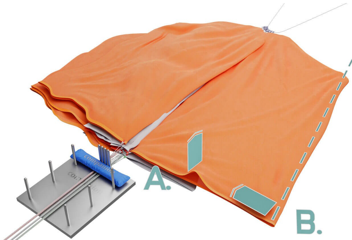
Obr. 12 Zatáhněte za oranžovou dráhu a podržte ji v bodech A a B.
