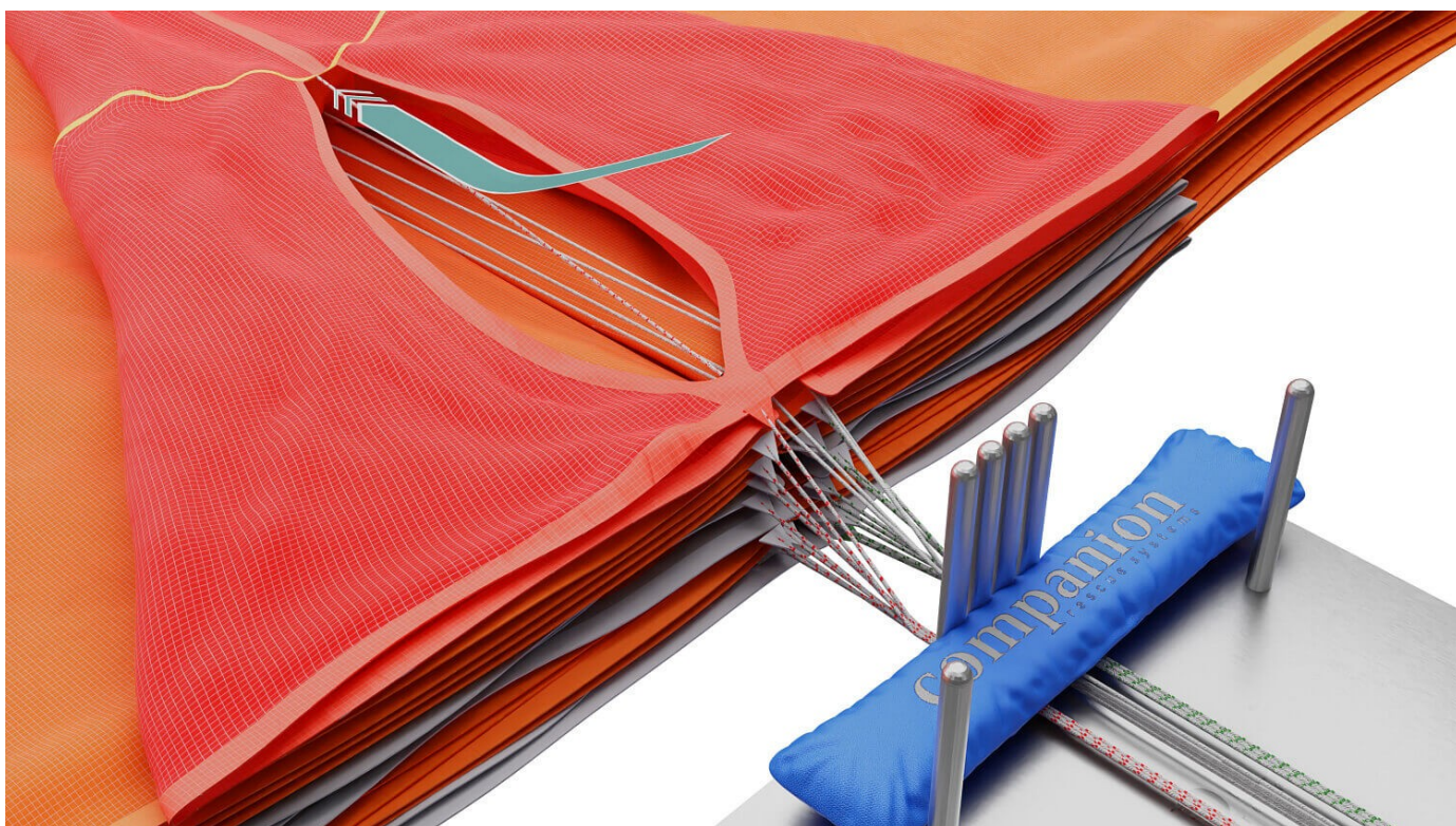
Obr. 33 Vyrovnajte střed vrchlíku a zatáhněte za středové šňůry směrem dolů.
