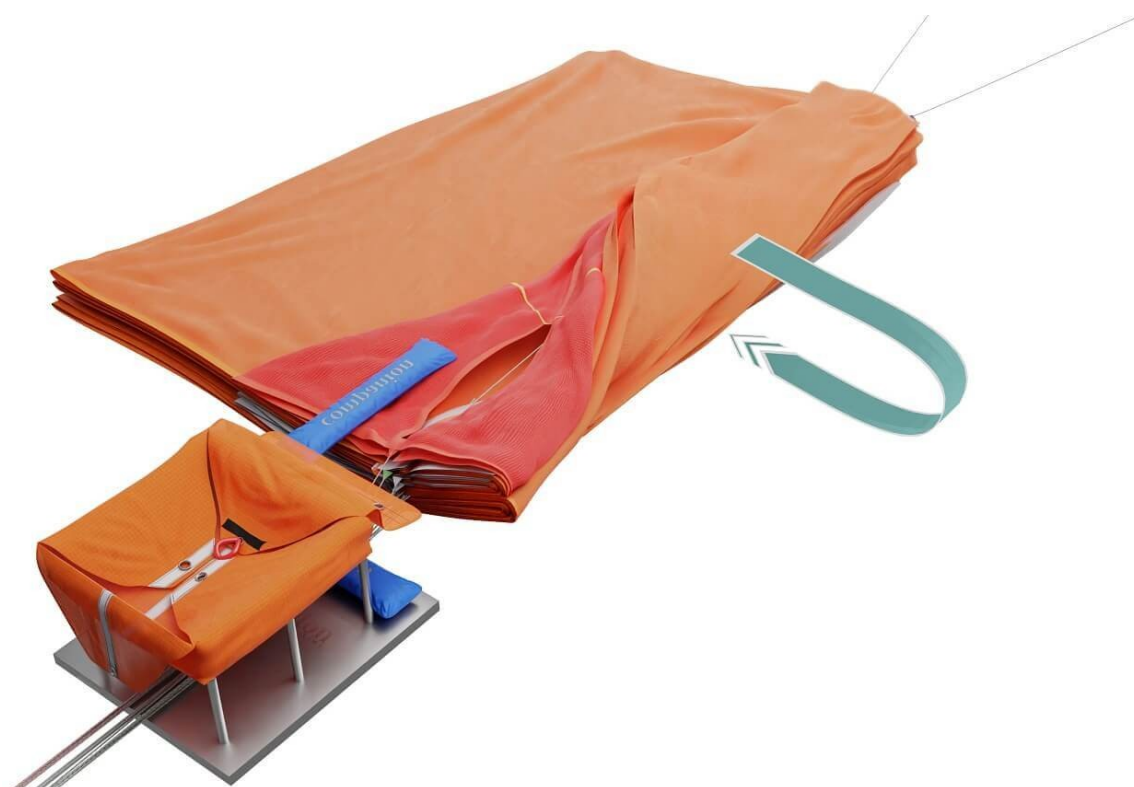
Obr. 37 Otočení S-úderu a následné podsunutí.
